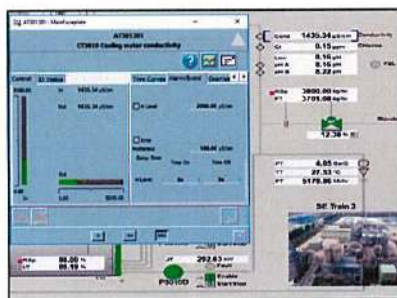
ภาพที่ 2.2- 24 การตรวจวัดคุณภาพน้ำหล่อเย็นผ่าน Conductivity Online
